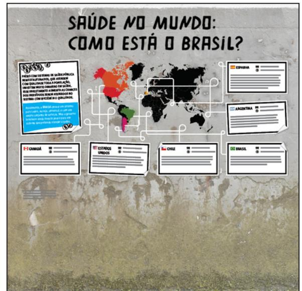
Impressão em vinil adesivo com laminação fosca aplicado sobre chapa de PS opaco 2mm fixado com fita VHB na estrutura de metalon. Formato total: 200x200cm, vinil impresso em duas partes. Arquivo: 10 andaime PRINT 1X 2X2M PS 1MM.pdf
