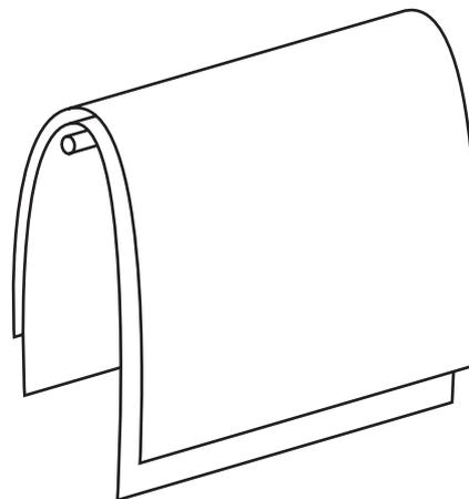
Cortina feita com tela de proteção de fachada, formato total 320x330cm. Duas camadas de tela passam por cima de um tubete de metal estruturante superior, e são fixadas em alguns pontos com fio de nylon. O resultado final é de 4 camadas. A distância da tela para a projeção é de 450cm.
