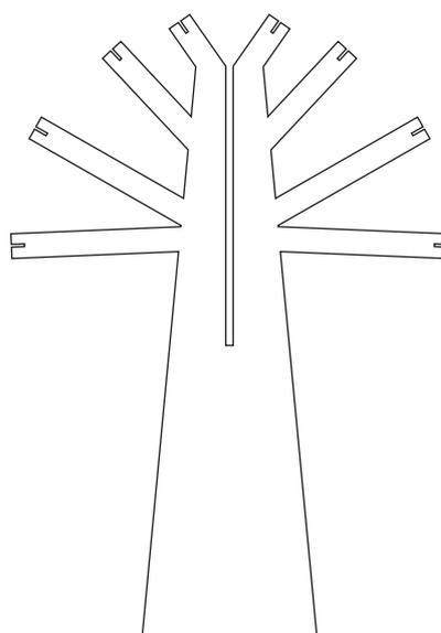
Duas peças de encaixe do tronco árvore D5 (a) recorte eletrônico em mdf 9mm de espessura sem tratamento, formato 82x137cm. Arquivos: árvore A 137 cm\_router.eps e árvore B 137 cm\_router.eps; duas peças de encaixe do tronco árvore D6 (b) recorte eletrônico em mdf 9mm de espessura sem tratamento, formato 82x117cm. Arquivos: árvore A 117 cm\_router.eps e árvore B 117 cm\_router.eps
