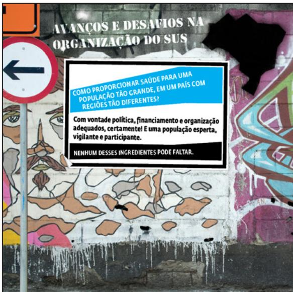
Impressão em vinil adesivo com laminação fosca aplicado sobre chapa de PS opaco 2mm fixado com fita VHB na estrutura de metalon. Formato total: 200x200cm, vinil impresso em duas partes.
