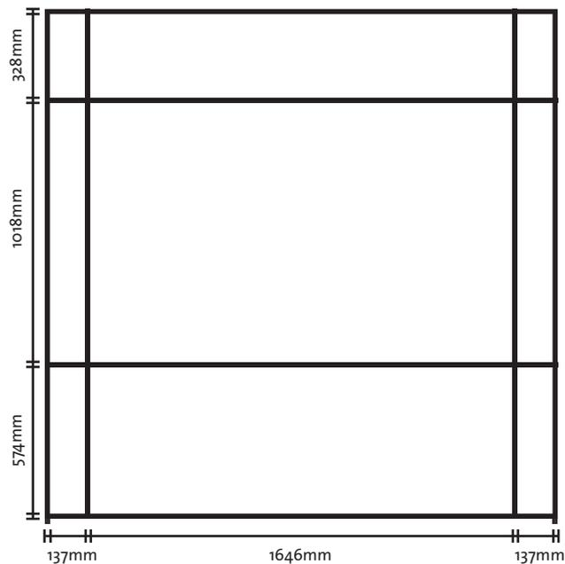
moldura de metalon com perfil de 2x2cm de 200x200cm, com duas hastes verticais e duas hastes horizontais.
